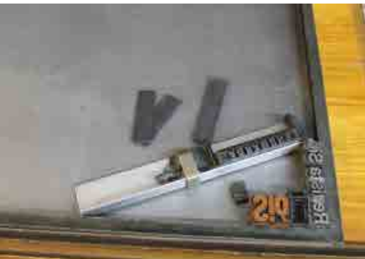
Componedor i galera amb diversos tipus d'impremta, quadrats i interlínies per espaiar.
