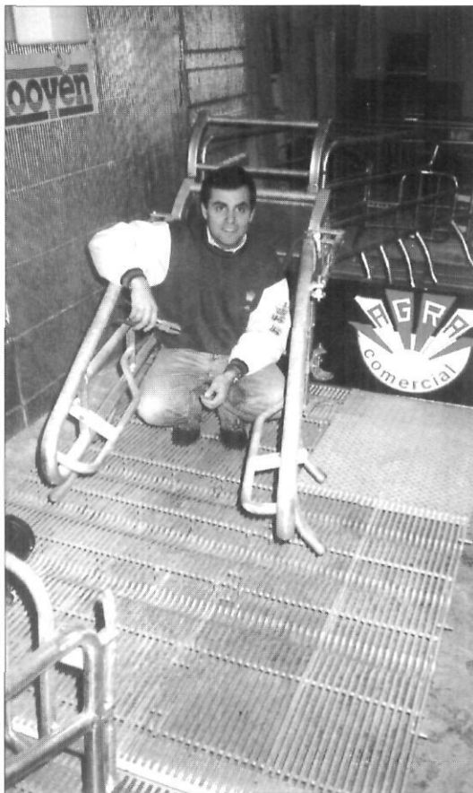
En Jordi Esteve instal·lant una paridera sobre el sistema de reixat amb calefacció. Un dels primers productes que van comercialitzar.
