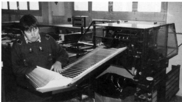
Les revistes van sortint de la màquina totalment acabades, un cop s'han cosit, doblegat i tallat.
