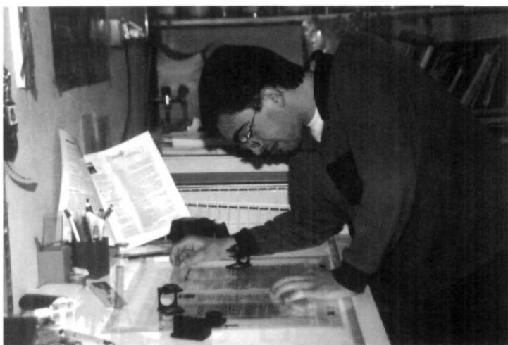
Taula de muntatge per compaginar els fotolits a l'"astralon", que un cop muntats s'insolaren a la planxa.
