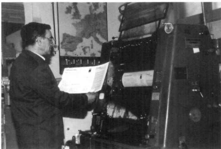
Màquina d'offset. El maquinista supervisa l'imprès abans d'iniciar el tiratge.
