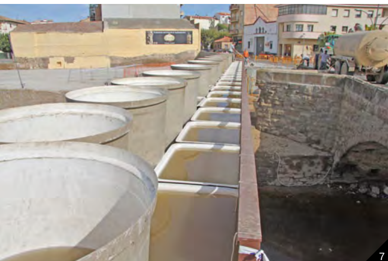
7. Amb els dipòsits plens es va comprovar el moviment descendent mitjançant uns sensors.
