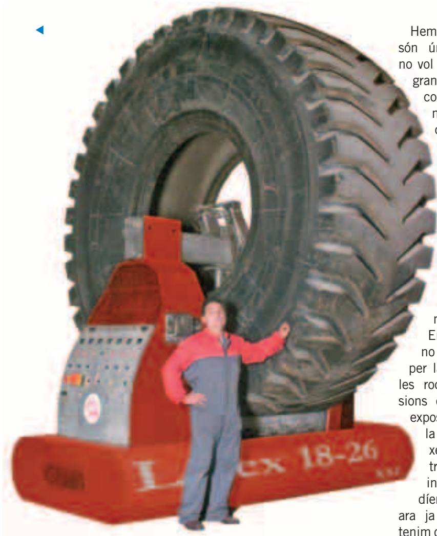
A dalt la moderna màquina Latex 18-26, que serveix per reparar rodes de grans dimensions.
